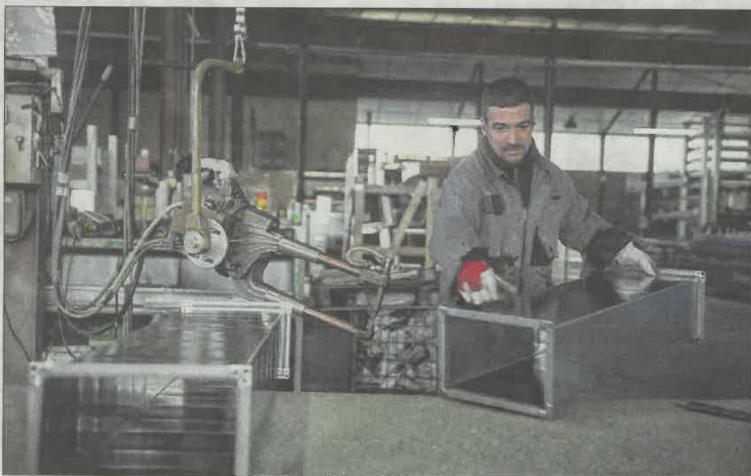
Teddy Breau s'attelle aux soudures des gaines, l'une des dernières étapes de fabrication.
